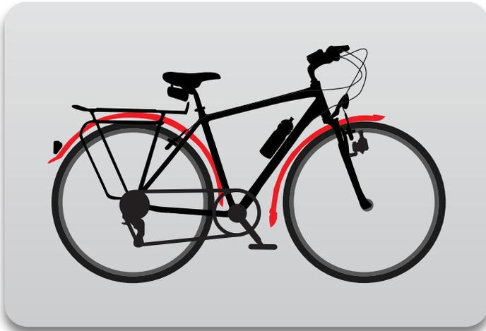
En algunas áreas y a consecuencia del clima, los guardabarros son una parte del equipamiento básico para las bicicletas. Se hace una distinción entre los guardabarros fijos y los modelos acoplables, que se utilizan principalmente en bicicletas de carretera y bicicletas de montaña. Cuando hace buen tiempo, pueden desmontarse de la bicicleta y guardarse en casa. En la siguiente sección, aprenderás a montar y alinear correctamente los guardabarros para evitar dañar y bloquear las ruedas.
