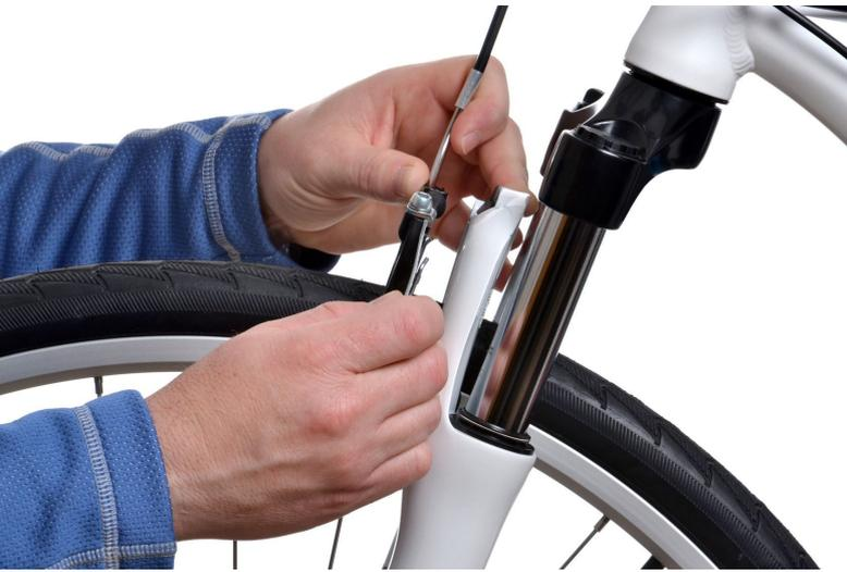
Si las pastillas de freno están gastadas y no tienen el perfil suficiente, deben ser reemplazadas. Esto funciona de la siguiente manera:
