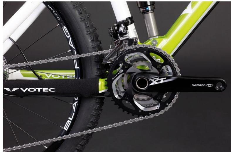
**II)** Si el desviador está a la distancia correcta de la cadena, ajusta el tope del desviador. Evita que el desviador delantero se balancee más hacia el exterior. Hay dos pequeñas barras transversales en el desviador delantero, indicadas por H y L. Importante es el tornillo-H: Este se gira hasta el momento hasta que alcanza una resistencia a girar más. Ahora, el desviador delantero no puede moverse más allá del plato más grande y evita que la cadena salte al cambiar.
